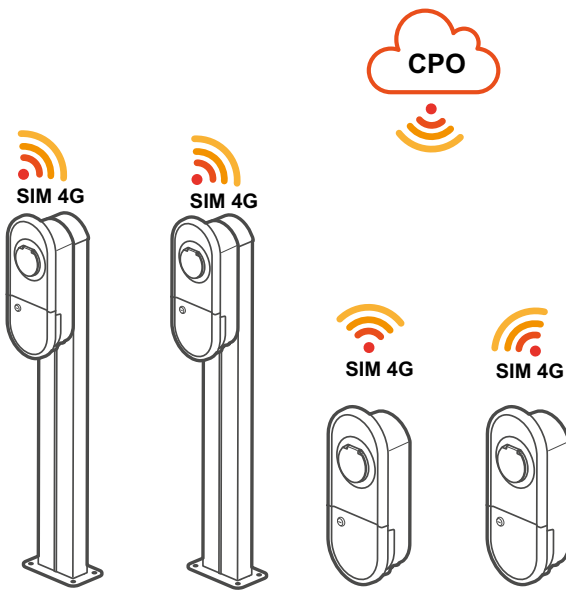
SCHÉMA DE PRINCIPE : RACCORDEMENT AVEC CARTE SIM POUR OPÉRATEUR DE CHARGE (CPO)
