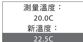
↙ ↘ 設置在室內測量的有效溫度
