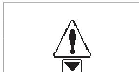
該畫面表示系統故障；按任何鍵可直接存取「診斷」功能表。
