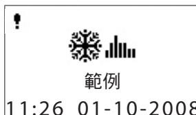
該圖示表示一個或多個系統區域中發生操作故障。
