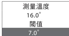
顯示幕顯示測量的溫度，並且在 ThermoConfig 編程需要時顯示閾值
