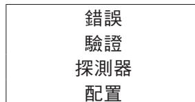
確保探測器配置正確( $P = CEN$ ) 並重試；若探測器不是此配置，它將無法通過控制單位進行配置。
