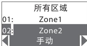
要使在“手动”模式下设置的区域 (数字突出显示) 处于正常操作模式 (常用系统模式)，请使用 键选择：
