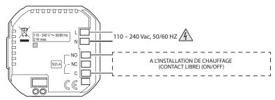
Installation pour chauffage uniquement avec charge à commander à la tension de secteur (ex. électrovanne 230 V)
