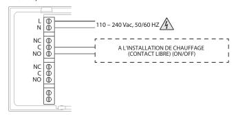
Installation pour chauffage uniquement avec charge à commander à la tension de secteur (ex. électrovanne 230 V)
