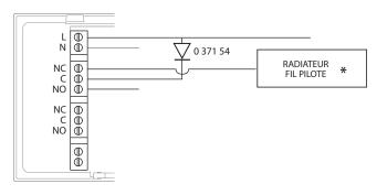
\* Pour assurer le bon fonctionnement du Smarther quand il est utilisé avec des radiateurs fil pilote, il est indispensable de régler le radiateur sur la température de CONFORT la plus élevée possible. Il n'est pas possible d'atteindre une température supérieure à celle de CONFORT programmée sur le radiateur, indépendamment de la valeur réglée sur le Smarther.
