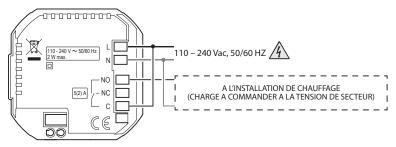
Chauffage et climatisation avec système au sol
