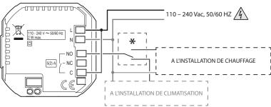
Installation de chauffage avec radiateurs fil pilote
