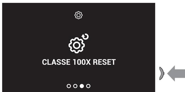
Pulse el joystick para resetear el dispositivo
