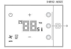
3. Exécute un scénario personnalisé : il est possible de personnaliser le graphisme des boutons au moment de la commande en se connectant au site https://uxforhotels.legrand.com et de configurer le scénario à exécuter à l'aide du logiciel Hôtel + Project.
