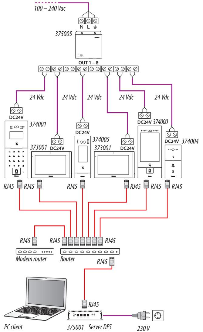
**Attenzione:** Questo dispositivo non supporta alimentatori POE standard, ma solo alimentatori POE identificati con 375002. Collegare il cavo cat5/5e/6 FTP o cat5/5e/6 UTP con ferrite in dotazione al connettore.
