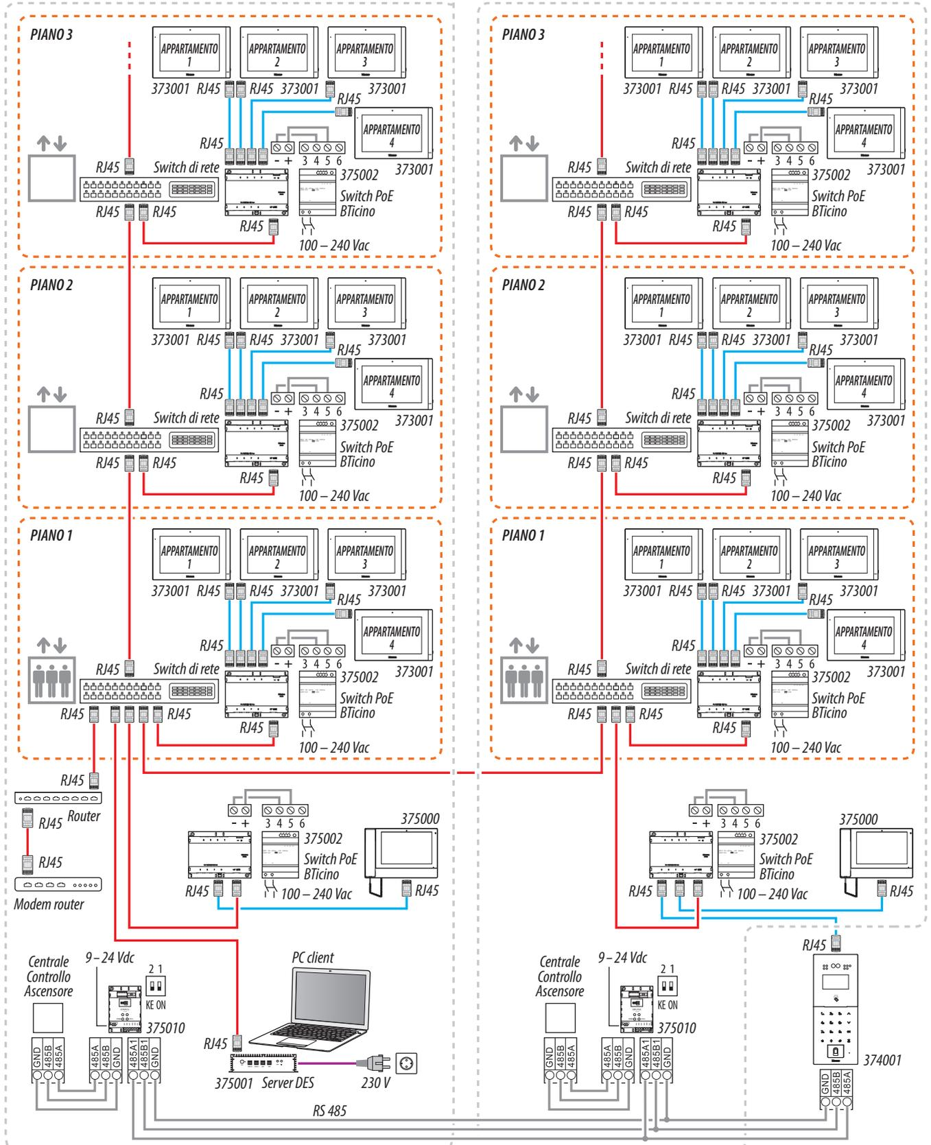
**Attenzione:** non collegare direttamente le porte PoE a un'interfaccia di rete non idonea, come ad esempio un dispositivo alimentato da una tensione diversa. Collegare la porta UP LINK a una porta idonea, mai a una porta PoE.
