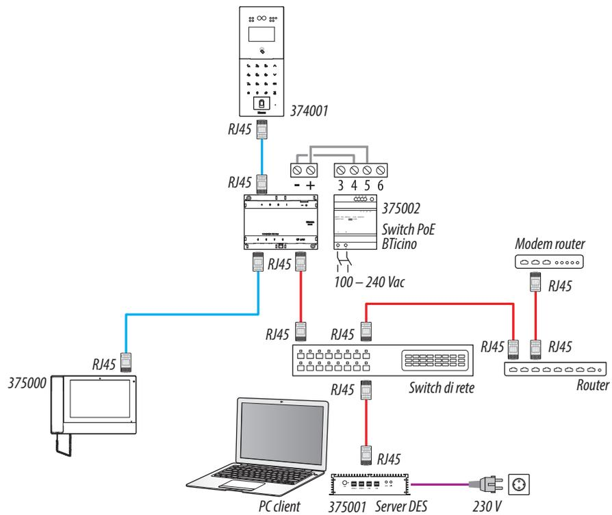
**Attenzione:** non collegare direttamente le porte PoE a un'interfaccia di rete non idonea, come ad esempio un dispositivo alimentato da una tensione diversa. Collegare la porta UP LINK a una porta idonea, mai a una porta PoE.
