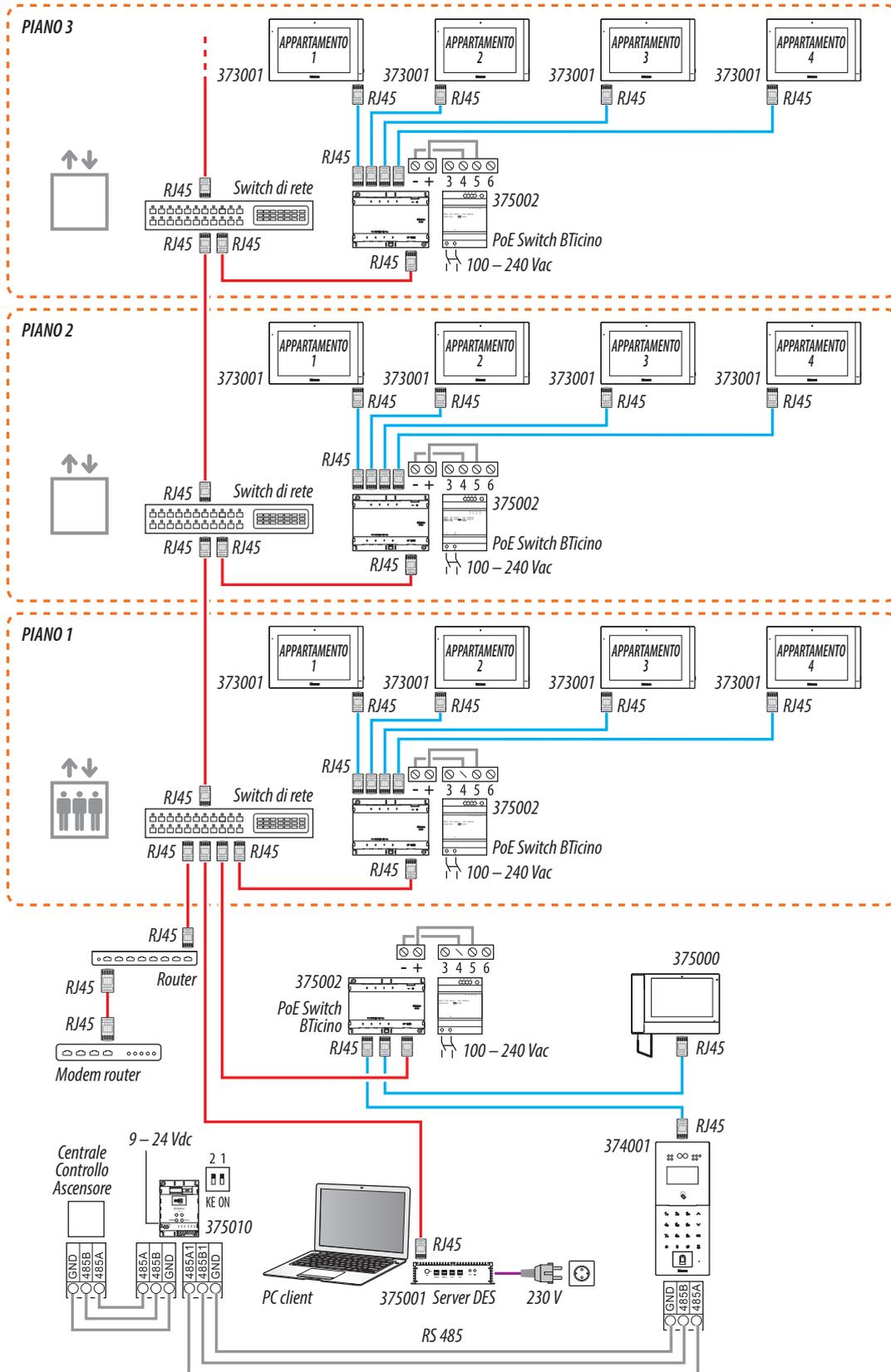
**Attenzione:** non collegare direttamente le porte PoE a un'interfaccia di rete non idonea, come ad esempio un dispositivo alimentato da una tensione diversa. Collegare la porta UP LINK a una porta idonea, mai a una porta PoE.
