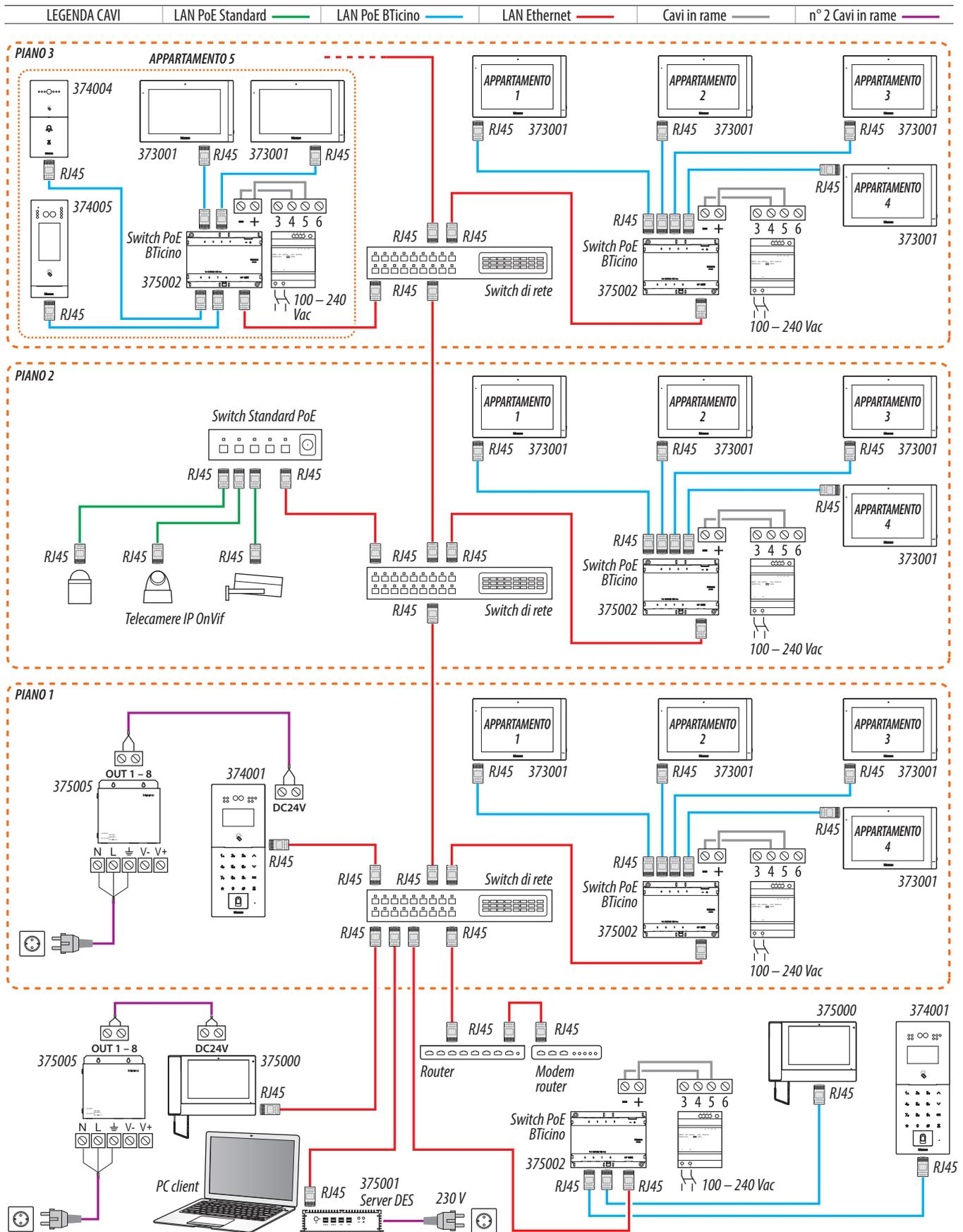
**Attenzione:** non collegare direttamente le porte PoE a un'interfaccia di rete non idonea, come ad esempio un dispositivo alimentato da una tensione diversa. Collegare la porta UP LINK a una porta idonea, mai a una porta PoE.
