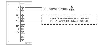
Installatie enkel verwarming met door netspanning aangestuurde lading (bijv. magneetklep 230Vac)
