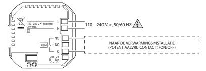
Installatie enkel verwarming met door netspanning aangestuurde lading (bijv. magneetklep 230Vac)
