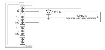
\* Voor een correcte werking van Smarther wanneer deze met fil pilote verwarmingselementen wordt gebruikt, moet op het verwarmingselement de hoogst mogelijke COMFORTtemperatuur worden ingesteld. Een hogere temperatuur van de COMFORT-temperatuur die op het verwarmingselement ingesteld is, niet worden gebruikt, ongeacht het setpoint dat op Smarther is ingesteld.
