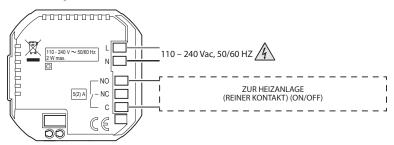
Anlage nur für Heizen mit durch die Netzspannung zu steuernde Stromlast (z.B. Magnetventil 230Vac)
