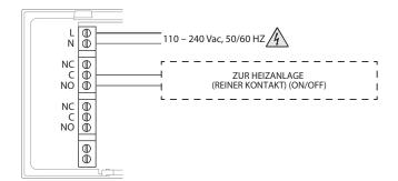
Anlage nur für Heizen mit durch die Netzspannung zu steuernde Stromlast (z.B. Magnetventil 230Vac)
