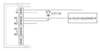
\* Für den korrekten Betrieb des Smarther in Verbindung mit Fil Pilote-Heizkörpern ist es wichtig, die höchstmögliche KOMFORT-Temperatur am Heizkörper einzustellen. Unabhängig von dem am Smarther eingestellten Sollwert, ist es jedoch nicht möglich, eine höhere Temperatur als die am Heizkörper selbst eingestellte KOMFORT-Temperatur zu erreichen.
