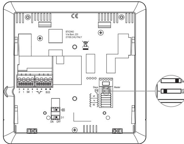
Den entsprechenden Mikroschalter auf ON positionieren
