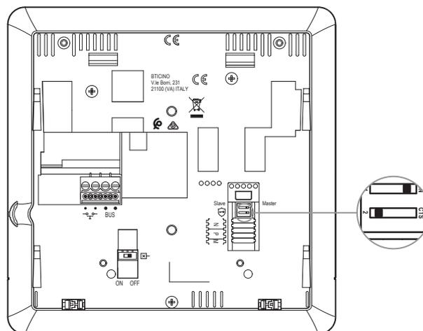
Desplace el microinterruptor correspondiente para situarlo en la posición ON
