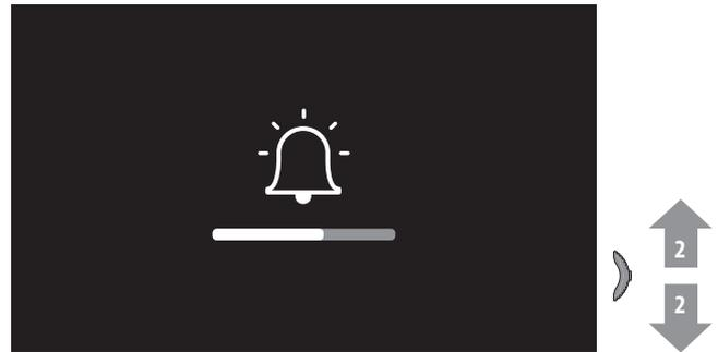
2 Accione el joystick hacia arriba/abajo para seleccionar el nivel (1 – 8) del volumen.
