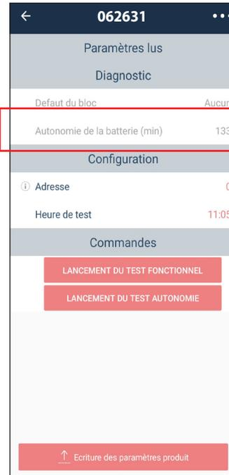
Ce paramètre permet de visualiser la durée de l'autonomie de la batterie (mesurée en minute) lors du dernier test trimestriel.
