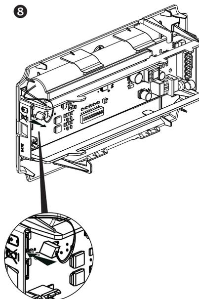
Les accumulateurs doivent être remplacés lorsque le bloc autonome ne satisfait plus à sa durée assignée de fonctionnement (LED jaune SATI allumée en continu).
