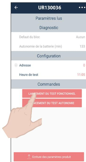
Après avoir cliqué sur test fonctionnel ou test d'autonomie, on visualise le résultat sur le bloc :
