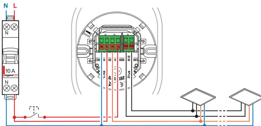
• Le relais est dédié à l'alimentation du ballast pour réduire la consommation d'énergie, la mise hors tension des ballasts est retardée de 5 minutes.
