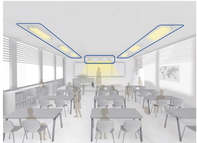
L'affectation des luminaires DALI dans les différentes zones se fait en utilisant l'application Close Up;
