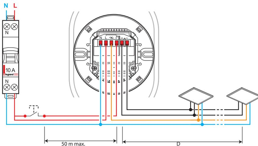
**!** Le relais est dédié à l'alimentation du ballast pour réduire la consommation d'énergie, la mise hors tension des ballasts est retardée de 5 minutes.
