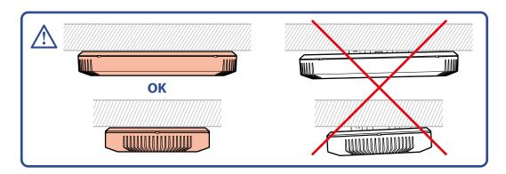
Orientation du capteur parallèle à un mur : il est conseillé d'orienter le détecteur dans le sens de déplacement de la porte vers le fond du local.
