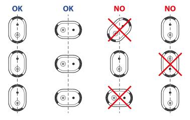
Pour éviter un comptage en doublon, positionner les détecteurs suffisamment éloignés (8 m). Si ce n'est pas possible → créer une zone d'exclusion sur les 2 capteurs pour exclure la zone de chevauchement.
