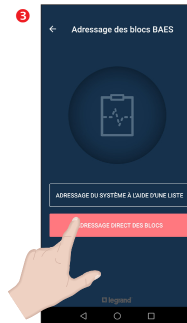
Cliquer sur "ADRESSAGE DIRECT DES BLOCS".
