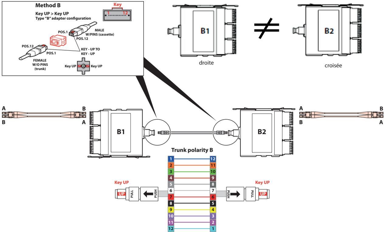
Pour les cassettes monomode en polarité B (traversée en « key-up/key-up »), le connecteur MTP mâle de la cassettes est « up-angled » selon l'IEC 61754-1-12 et donc seulement compatible avec des trunks MTP (ou MPO) femelle polarité B standards (« down-angled »). Trunks polarité B disponibles à la demande.
