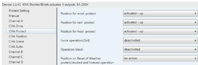
Fig.7.5 parameter window "CHA Protect"
