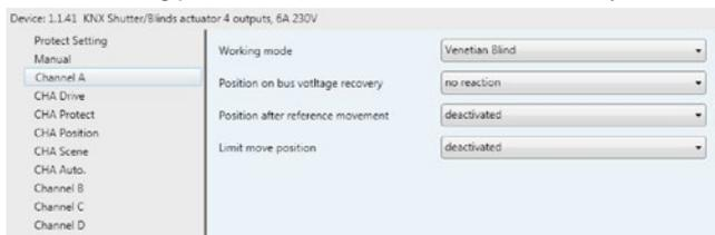
Fig.7.3 parameter window "Channel X"
