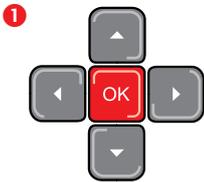
1 Schalten Sie das Konfigurationstool ein, indem Sie 2 Sekunden lang die OK-Taste drücken.
