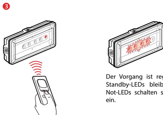
Der Vorgang ist registriert, die Standby-LEDs bleiben an, die Not-LEDs schalten sich zweimal ein.
