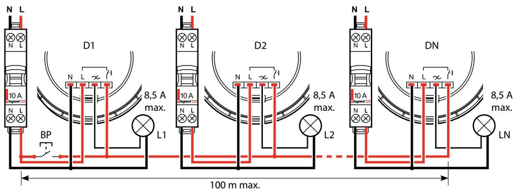
■ 4.3 Câblage avec mise en parallèle pour une seule charge
