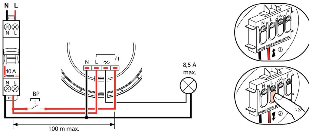
■ 4.2 Câblage avec mise en parallèle pour plusieurs charges
