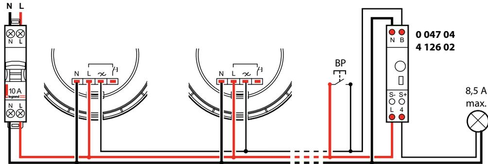
Avec ce câblage, l'outil de configuration doit être sur « Pulse » (voir paragraphe 8. Réglage).
