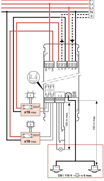
Les deux voies sont synchronisées, cela permet de placer les luminaires en quinconce avec une phase d'alimentation des ballasts sur chaque voie.
