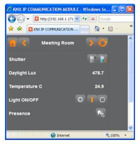
Le pagine Web sono accessibili tramite l'indirizzo IP che è stato assegnato nella configurazione ETS.
