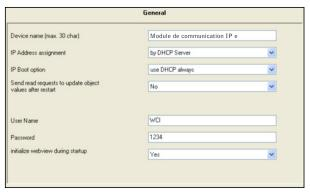
In particolare, è possibile indicare il tipo di identificazione e il modo in cui l'indirizzo IP viene assegnato.
