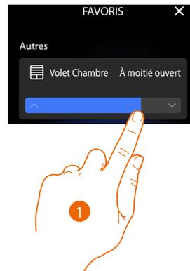
1. Toucher et glisser vers la droite/gauche pour ouvrir/fermer le volet jusqu'au point voulu ; en fin de pression, la commande est exécutée. L'objet montre ensuite l'état d'ouverture du volet
