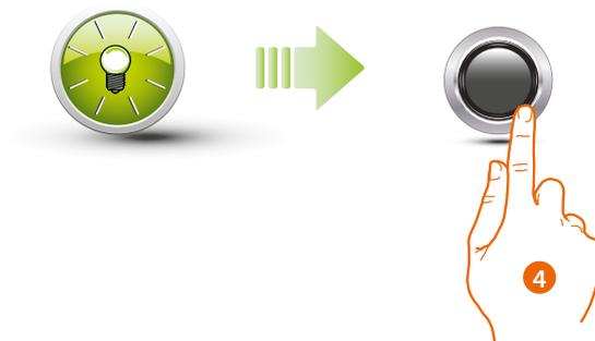
4. Carregar brevemente o botão ou aguardar 30 segundos para sair do procedimento. Um beep breve e a desligação do LED indica o fim da sequência de programação. O Leitor de Proximidade Sfera está pronto para o normal funcionamento.
