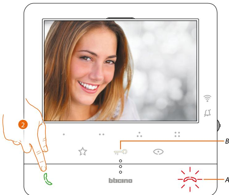
2. Toque para responder a la llamada, el LED se apaga; para acabar la llamada, toque la tecla (A) y para abrir la cerradura de la placa exterior, toque la tecla (B)
