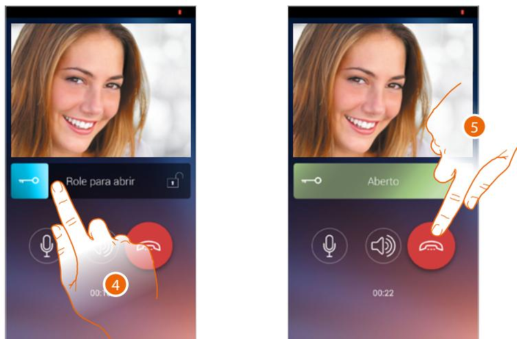
4. Além disso, pode abrir a fechadura da Unidade Externa da qual provém a chamada, arrastando o interruptor, quando o mesmo se torna verde a fechadura foi ativada, no caso no qual permaneça vermelho, o comando não foi executado corretamente.
