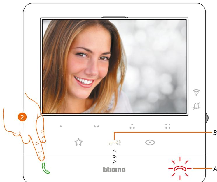
2. Tocar para responder à chamada, o LED apaga-se, para terminar a chamada tocar na tecla (A) e para abrir a fechadura da Unidade Externa tocar na tecla (B)
