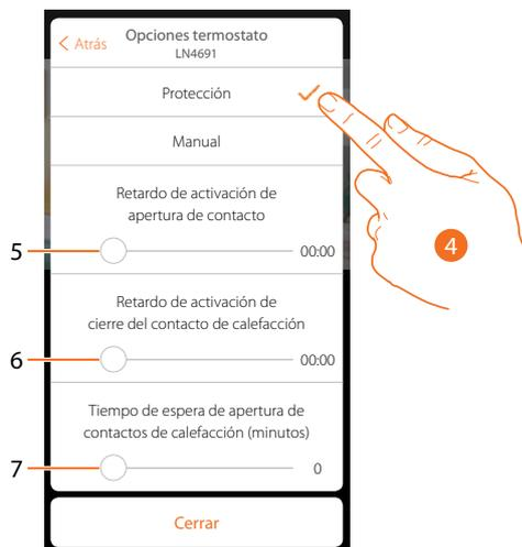
4. Toque para programar la instalación de protección térmica o antihielo durante la/el apertura/cierre del contacto
