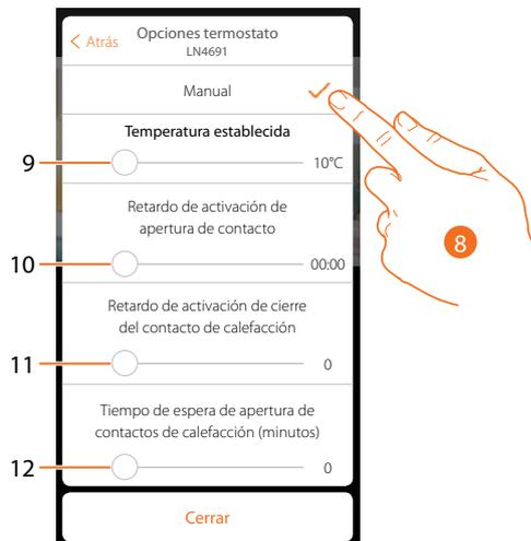
8. Toque para programar la instalación a una temperatura determinada durante la/el apertura/cierre del contacto
