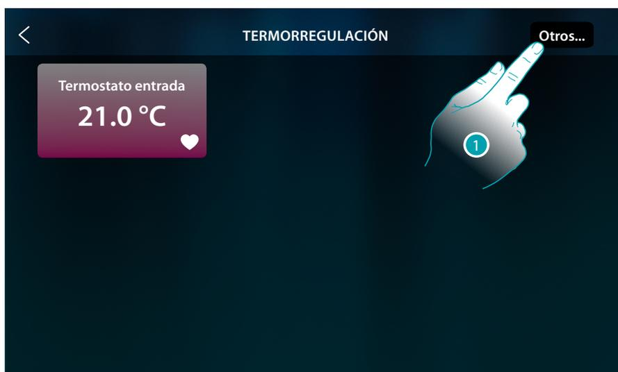
1. Toque para ajustar el modo operativo de la instalación entre calefacción y refrigeración
