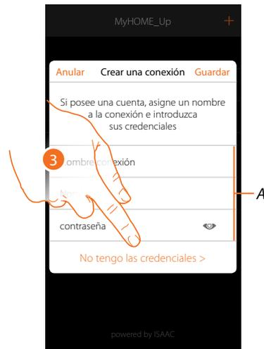
3. Toque para crear la conexión y acceder mediante la red local con el INSTALLER CODE
