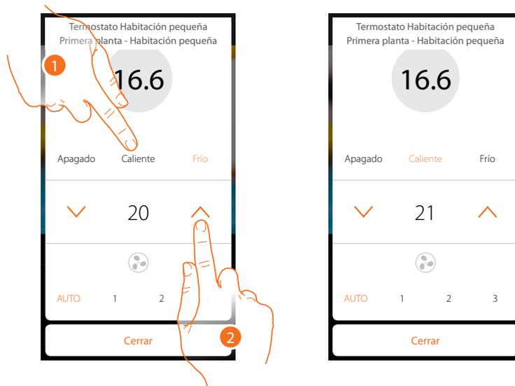
1. Toque para seleccionar el modo en el que se ajustará la instalación
