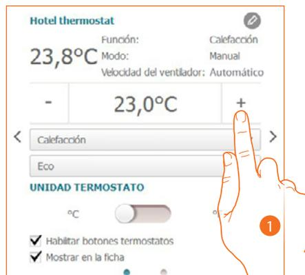
1. Toque para aumentar o disminuir la temperatura que ajustar en la habitación; en función de la temperatura medida la instalación se enciende o apaga
