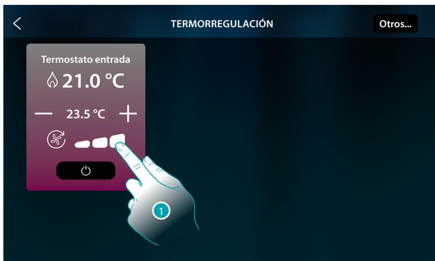
1. Toque para configurar la velocidad del ventilador en el nivel elegido
