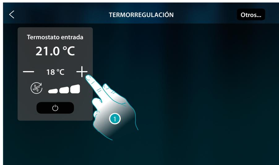
1. Toque para aumentar o disminuir la temperatura que ajustar; en función de la temperatura medida la instalación se enciende o apaga
