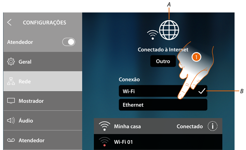
A Indicação do estado e do tipo de conexão
