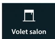
**Volet avec réglage du niveau d'ouverture** : ouvre, ferme progressivement, arrête et visualise l'état d'un volet
