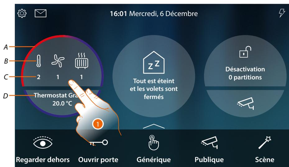
A Indique par une couleur (rouge pour chauffage et bleu ciel pour climatisation) qu'au moins un des dispositifs est dans l'état actif.
