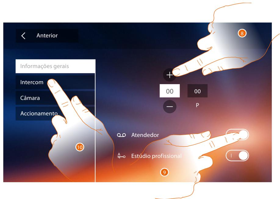
8. Introduzir os valores do configurador N a fim de definir o endereço do dispositivo e os valores do configurador P a fim de definir o endereço da UE da qual é aberta a fechadura com a UI em repouso e à qual endereçar a ligação automática.
