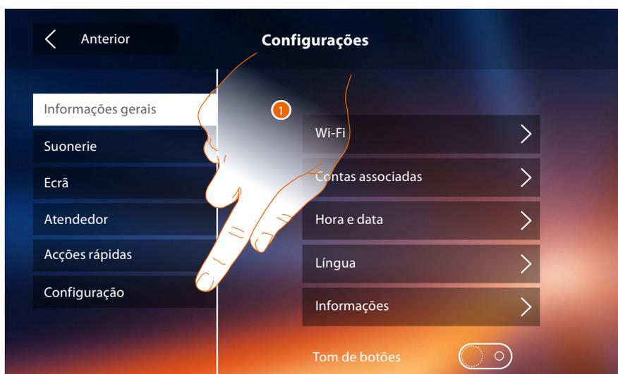
1. Tocar para configurar o dispositivo, gerir os dispositivos compatíveis, enviar relatórios à assistência técnica, reiniciar o dispositivo e/ou as configurações do Wi-Fi.
