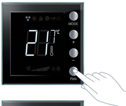
可选择设置设备的计量温度表示为 $^{\circ}\text{C}$ 或 $^{\circ}\text{F}$ 。
