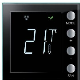
几秒钟后将保存新的设置并显示测得的温度（温度计图示亮起）。
