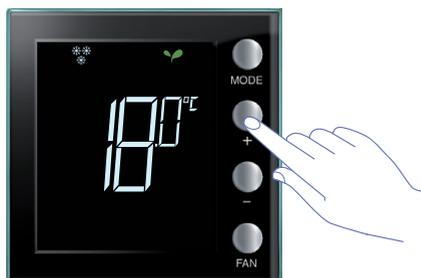
Es wird das Symbol des neuen Modus angezeigt und die Anzeige der eingestellten Temperatur blinkt (Symbol Thermostat aus). Über die Tasten **+** und **-** kann die Einstellung geändert werden.
