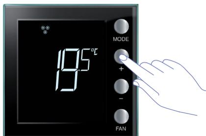
Über die Tasten + oder – kann die aktuelle Temperatureinstellung geändert werden.
