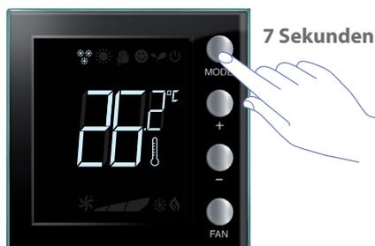
Um von der Funktion Heizen auf die Funktion Kühlen und umgekehrt umschalten zu können, halten Sie die Taste MODE mindestens 7 Sekunden lang gedrückt.
