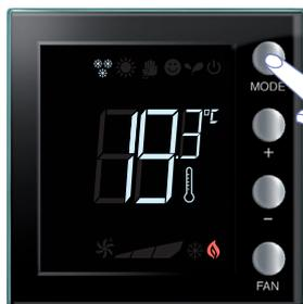
Um vom normalen Betrieb auf den Modus Frostschutz (oder Temperaturschutz) überzugehen, die Taste **MODE** drücken.
