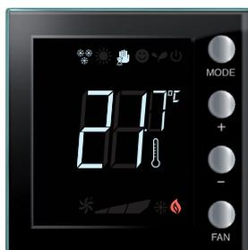
Nach einigen Sekunden wird die neue Einstellung gespeichert und die gemessene Temperatur angezeigt. In diesem Beispiel ist die eingestellte Temperatur höher als die gemessene; daher leuchtet auch die Anzeige für Heizung in Betrieb
