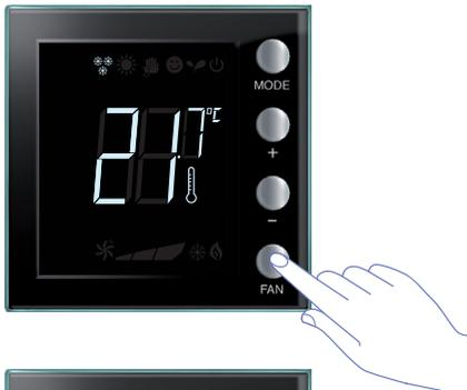
Die Temperatur kann an der Vorrichtung entweder in °C oder °F angezeigt werden.
