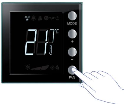
Drücken Sie zwei Mal die Taste **FAN**, um die Einstellung zu bestätigen und die Funktion zu beenden.
