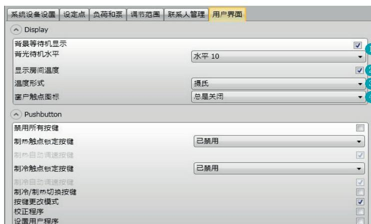
1. 背光:可设置恒温器待机时显示屏的背光，确定是否启用背光。如启用背光，可设置背光的亮度水平。
