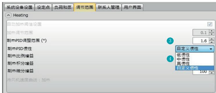
3. PID（比例-积分-微分）调节范围：相对于设置的设定点，这个参数决定了恒温器进行干预的范围。
