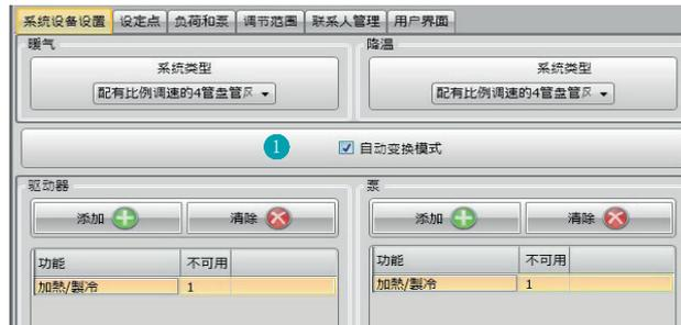
1. 自动变换模式= 在有已启用制热和制冷功能的4管盘管风机的系统设备或有独立水循环系统进行制热和制冷的系统设备上，可启用这个功能对切换制热和制冷进行自动管理。
