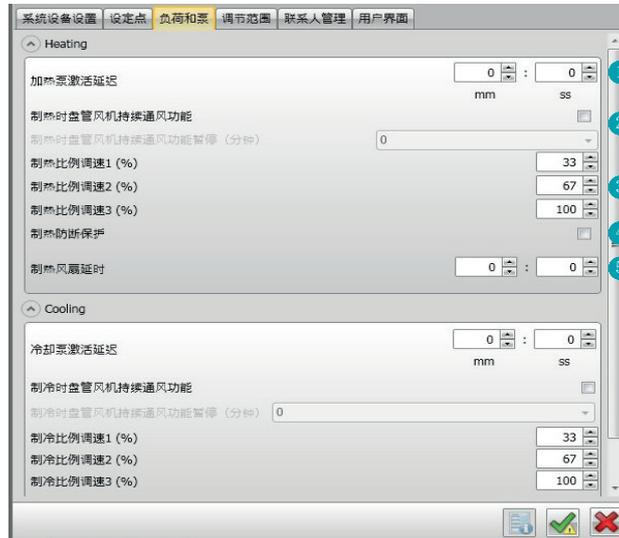
1. 泵启动延迟：可设置延迟泵启动的时间，避免泵在指定的阀门打开之前启动。
