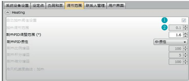
1. 自动阈值设置：启用这个参数后，调节范围将为默认状态（0.1 ° C）。禁用这个参数后，可进行如下设置。
