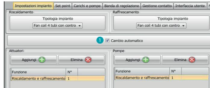
1. **Cambio automatico** = in impianti con fancoil 4 tubi abilitati sia al riscaldamento che al raffreddamento oppure in impianti in cui i sistemi di circolazione dell'acqua per riscaldamento e per raffreddamento sono del tutto indipendenti, puoi abilitare questa funzione per gestire automaticamente la commutazione tra riscaldamento e raffreddamento.
