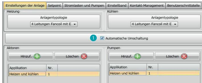
1. **Automatische Umschaltung** = In Anlagen mit 4 Leitungen Fancoil, die sowohl dem Heizen als auch dem Kühlen dienen oder in Anlagen wo der Wasserumlauf für das Heizen und das Kühlen unabhängig ist, können Sie diese Funktion aktivieren, um automatisch von Heizen auf Kühlen und umgekehrt umzuschalten.
