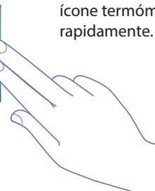
Carregar simultaneamente nas teclas + e – (> 7 segundos); o ícone termómetro começa a piscar rapidamente. Soltar as teclas.
