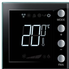
Após a conclusão do lampejo o novo set-point é memorizado (visualização fixa do set-point) e, em seguida, o display volta a visualizar a temperatura medida.
