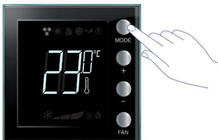
A programação da função (com exclusão de utilização como sonda MyHOME) pode ser alterada com uma carga prolongada da tecla **MODE** (> 7 segundos). É possível desabilitar a troca de função (por meio do botão Mode (através de configuração por meio do software MyHOME\_Suite).
