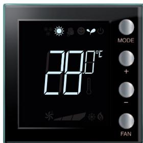
Sul display viene visualizzato il set point impostato per la funzione riscaldamento o raffreddamento.
