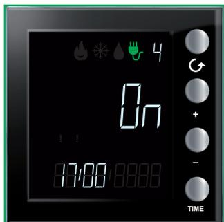
Si hay un **actuador avanzado**, tras haber seleccionado la línea, se puede visualizar sus datos de consumo al presionar la tecla "TIME".
