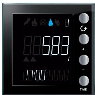
**Estado del actuador en el modo de control de cargas:** se destaca el estado del actuador, On u Off, el icono de control de cargas, el número de la línea y la hora corriente.
