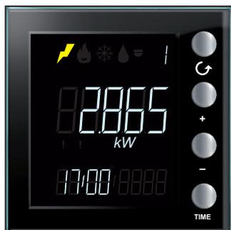
Si hay un **actuador base**, el dispositivo Energy Display visualiza solamente el estado del actuador **On** u **OFF**; la tecla "TIME" no tiene efectos. Con una breve presión de las teclas "+" y "-" puede forzar el estado del actuador ([ver párrafo correspondiente](#)).
