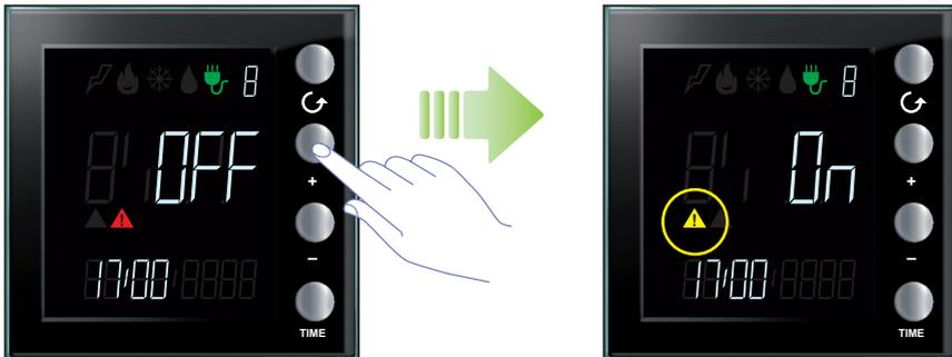
**Status der deaktivierten und forcierten Stromlasten:** Wenn mehrere mit dem Energy Display verbundene Stromlasten deaktiviert und einige davon (nicht alle) forciert wurden, werden beide Warnsymbole angezeigt. Das rote Warnsymbol wird unabhängig von der kontrollierten Leitung angezeigt, während das gelbe Warnsymbol nur aufleuchtet, wenn die entsprechende forcierte Stromlast angezeigt wird.
