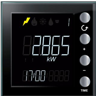
Falls ein **Basis-Aktor** installiert ist, zeigt das Energy Display nur den Status des Aktors (**On** oder **Off**) an. Die Taste "TIME" hat keine Wirkung. Werden die Tasten "+" e "-" kurz gedrückt, kann der Status des Aktors forciert werden ([siehe entsprechenden Abschnitt](#)).
