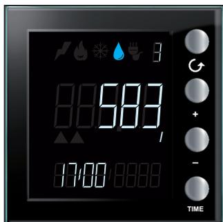
**Zustand des Aktors im Modus Stromlastkontrolle:** Es werden der Status des Aktors (On oder Off), das Symbol der Stromlasten, die Nummer der Leitung und die laufende Uhrzeit angezeigt.
