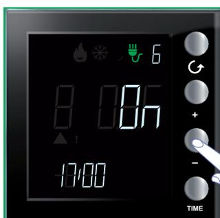
Для устранения условия принудительной активации нагрузки до окончания 4-часового интервала нажмите на клавишу “-”.
