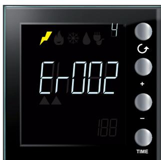
Сигнализация ошибки на одной из линий (от Er001 до Er255). Проверьте работу указанной линии.
