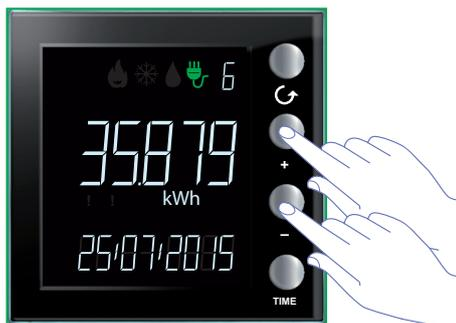
Для обнуления счетчиков нажимайте одновременно на клавиши "+" и "-" более 7 секунд.
