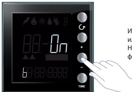
Используйте клавиши “+” и “-” для подключения или отключения звукового сигнала. На дисплее появится символ “b” и состояние функции ON или OFF.
