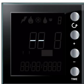
В случае быстрого мигания этой страницы необходимо проверить физическое конфигурирование. Для получения дополнительной информации обращаться к техническому паспорту устройства.
