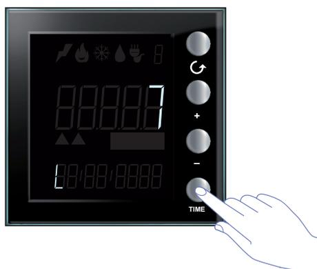
Pressionar a tecla TIME uma vez para ir para a próxima fase de configuração.
