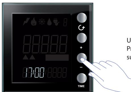
Utilizar as teclas “+” e “-” a fim de ajustar a hora. Pressionar a tecla TIME para ajustar os minutos e sucessivamente configurar a data.
