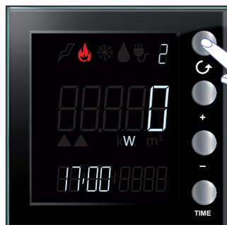
Manter a tecla ↵ pressionada por mais de 7 segundos a fim de aceder à secção de configuração do coeficiente.
