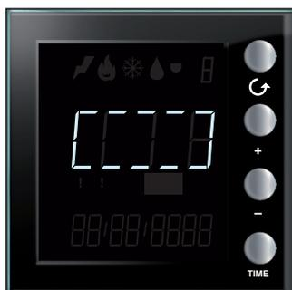
Este símbolo é exibido apenas na presença de configuração física, nos casos de não execução da auto-aprendizagem ou, após a execução da mesma, de não deteção de um dispositivo a partir do qual extrapolar os dados de consumo. Verificar a configuração e repetir o procedimento de auto-aprendizagem ([consultar Auto-aprendizagem](#))
