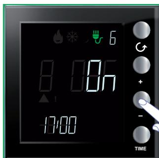
Para eliminar a condição de forçamento da carga antecipadamente em relação as 4 horas pressionar a tecla "-"
