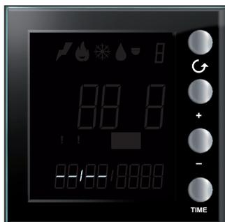
Uma correcta configuração dos valores de hora e data é indispensável para o funcionamento do Energy Display. O símbolo ao lado está a indicar a ausência de qualquer configuração.
