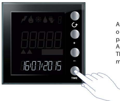
Através do software MyHOME\_Suite é possível alterar o formato de visualização da data de GG:MM:AAAA para MM:GG:AAAA. Ao término da configuração da data pressionar a tecla TIME a fim de memorizar os ajustes realizados e sair do menu.
