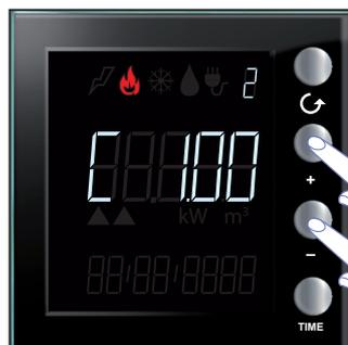
Utilizar as teclas "+" e "-" a fim de configurar o coeficiente correcto.
