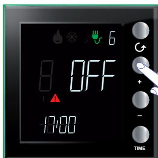
Após seleccionar a linha interessada pressionar a tecla "+" para forçar o estado da carga
