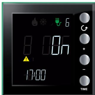
O forçamento é evidenciado por meio da exibição do ícone amarelo, enquanto o estado do actuador é alterado de OFF para ON.
