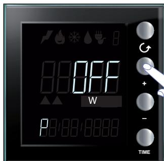
Utilizar as teclas “+” e “-” a fim de ajustar o valor do limiar relativo ao consumo eléctrico (o valor é expresso em watts e pode ser configurado de 1 a 65535 ou ainda OFF).
