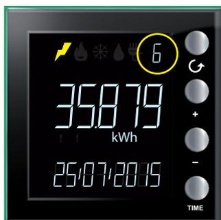
Após as configurações iniciais, o Energy Display procede com a aquisição dos dados armazenados pelos dispositivos de medição.
