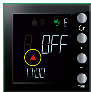
Przykład obciążenia wyłączzonego na linii Nr 6
