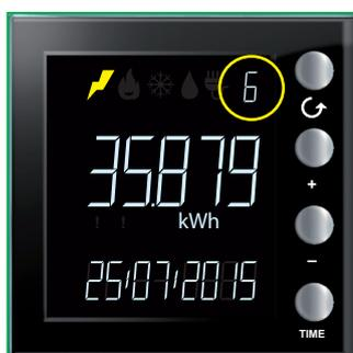
Tras los ajustes iniciales, Energy Display pasa a la adquisición de los datos memorizados por los dispositivos de medida. Durante la primera adquisición de los datos, la pantalla es la de al lado; el identificador de la línea afectada parpadea lentamente.
