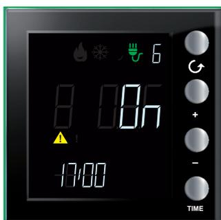
El forzado se destaca con la aparición del icono amarillo mientras que el estado del actuador cambia de OFF a ON.
