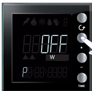
Use las teclas “+” y “-” para configurar el valor del umbral relativo al consumo eléctrico (El valor se expresa en vatios y se configura de 1 a 65535 u OFF). La superación del umbral se indicará con 5 beeps breves (con el buzzer habilitado) mientras que un beep prolongado indicará que los consumos se ajustan de nuevo a los límites programados.
