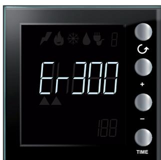
Indicación de error grave (de Er300 a Er303). Póngase en contacto con la asistencia técnica.
