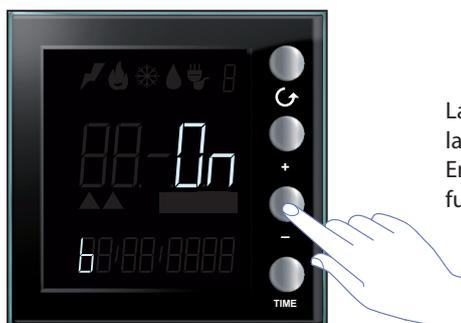
Las teclas "+" y "-" le permiten habilitar o deshabilitar la señal acústica. En la pantalla aparece el símbolo "b" y el estado de la función ON u OFF.
