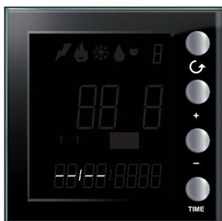
El ajuste correcto de la hora y la fecha es indispensable para el funcionamiento de Energy Display. El símbolo lateral indica que no se ha efectuado el ajuste. Efectúe el ajuste, de lo contrario el dispositivo no podrá funcionar ([véase Hora y Fecha](#)).
