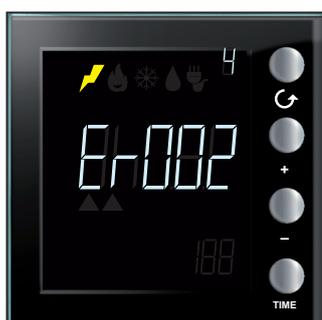
Señalización de error en una de las líneas (de Er001 a Er255). Verifique el funcionamiento de la línea indicada.
