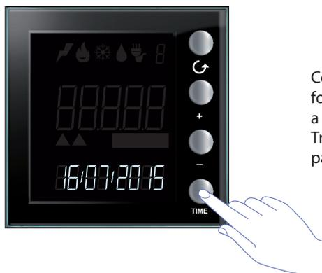
Con el software MyHOME\_Suite puede cambiar el formato de visualización de la fecha de DD:MM:AAAA a MM:DD: AAAA. Tras haber programado la fecha, presione la tecla TIME para memorizar los ajustes y salir del menú.
