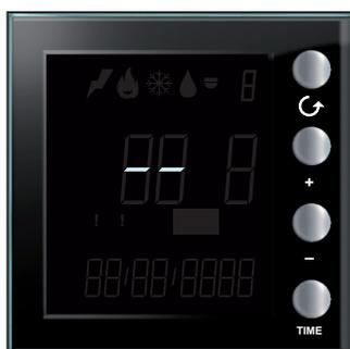
Si esta pantalla parpadea rápidamente, controle la configuración física; consulte la ficha técnica del dispositivo para obtener más información.
