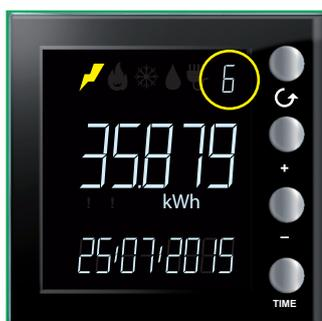
Nachdem das Energy Display eingestellt worden ist, beginnt es die Daten, die in der Messvorrichtung gespeichert sind, zu erfassen. Während der ersten Datenerfassung sieht das Display wie seitlich abgebildet aus; die ID der gemessenen Leitung blinkt langsam.
