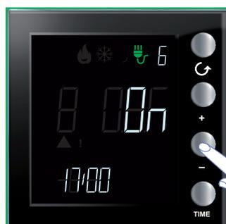
Um den Forcierungszustand der Stromlast vorzeitig, also vor Ablauf der 4 Stunden zu löschen, drücken Sie die Taste "-"
