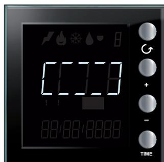
Dieses Symbol wird nur angezeigt, wenn bei der physischen Konfiguration die Selbstlernfunktion nicht durchgeführt oder wenn nach Abschluss keine Vorrichtung gefunden wurde. Kontrollieren Sie die Konfiguration und starten Sie die Selbstlernfunktion von neuem ([siehe Selbstlernfunktion](#))
