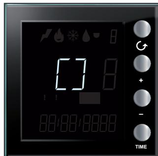
Das angezeigte Symbol blinkt langsam; abwarten bis die laufende Konfiguration beendet ist.
