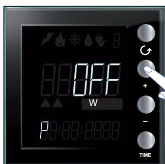
Verwenden Sie die Tasten “+” e “-” um den Wert der Stromverbrauchsschwelle einzustellen (der Wert ist in Watt ausgedrückt und kann zwischen 1 und 65535 oder auf OFF eingestellt werden).
