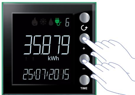
Drücken Sie die Taste „+“ e „-“ gleichzeitig mehr als 7 Sekunden lang, um die Zähler auf Null zurück zu stellen.
