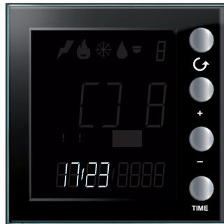
Das angezeigte Symbol blinkt schnell; die Vorrichtung muss konfiguriert werden.
