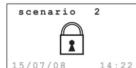
Impianto disinserito, segnalazione di allarme generico, tamptest con impianto disinserito o batteria di un dispositivo radio scarica
