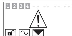
Impianto disinserito, batteria del sistema antifurto scarica o guasta e segnalazione di allarme tecnico
