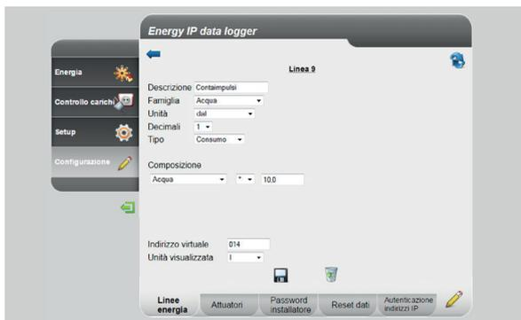
Presupponiamo di avere un consumo di 280 l/h, non è possibile misurare il consumo con un'interfaccia contaimpulsi perchè può misurare massimo 254 impulsi/ora. Tramite l'operatore moltiplicazione possiamo ovviare al problema:
