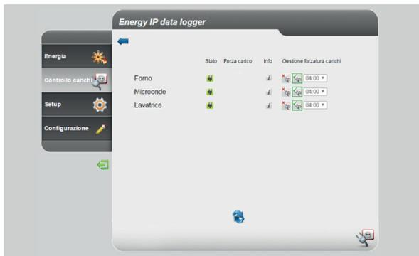
Nel caso in cui la centrale rileva un sovraccarico sull'impianto, viene disattivato il carico con priorità minore, a questo punto puoi riattivare forzatamente il carico.
