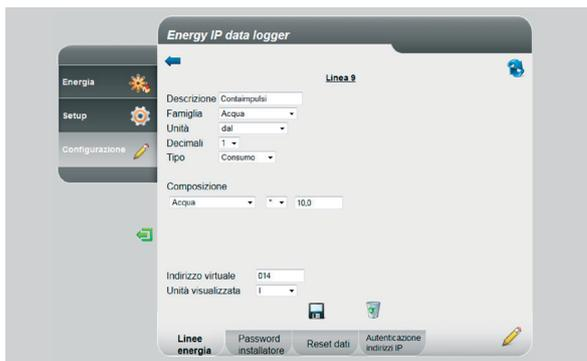
Presupponiamo di avere un consumo di 280 l/h, non è possibile misurare il consumo con un'interfaccia contaimpuls perchè può misurare massimo 254 impulsi/ora. Tramite l'operatore moltiplicazione possiamo ovviare al problema:
